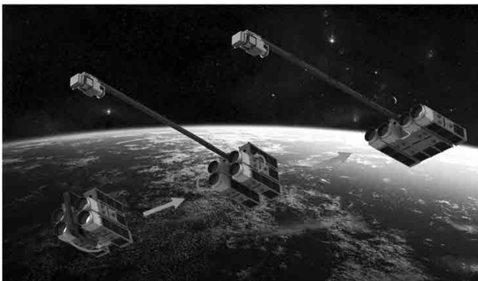
图 2.4 可重构空间望远镜自动组装(AAReST)任务概念:直径为 10 cm 的圆形镜面安装在一组立方星上[图片来源:加州理工学院 AAReST 团队 ( http://www.pellegrino.caltech.edu/aarest1/ )]
