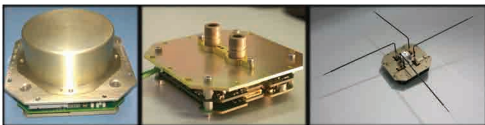
图 3.7 欧盟 QB50 项目的三种类型科学传感器(从左到右):离子与中性质谱仪(INMS)、通量- \Phi 探针实验(FIPEX)和多针朗缪尔探头(m-NLP)[图片来源:欧盟 QB50 项目科学小组( https://www.qb50.eu/ )]
